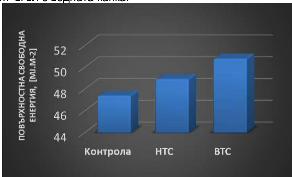
Фиг. 1.1.3.24. Изчислени стойности на повърхностната свободна енергия (НТС - нискотемпературно стерилизирана; ВТС - високотемпературно стерилизирана проба)
